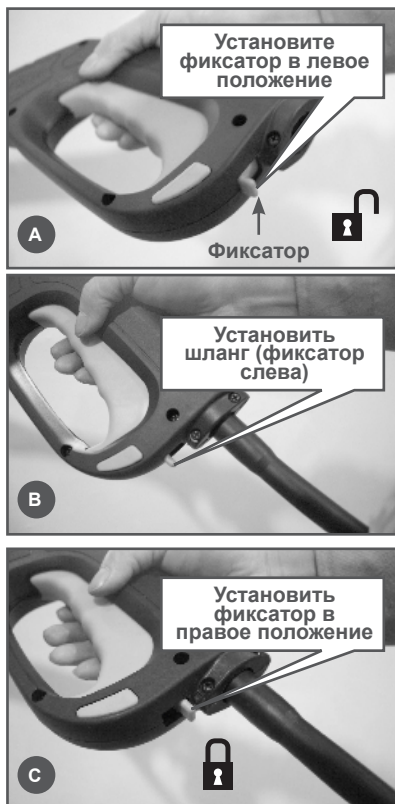
Рис. 3 Подключение шланга высокого давления к пистолету
