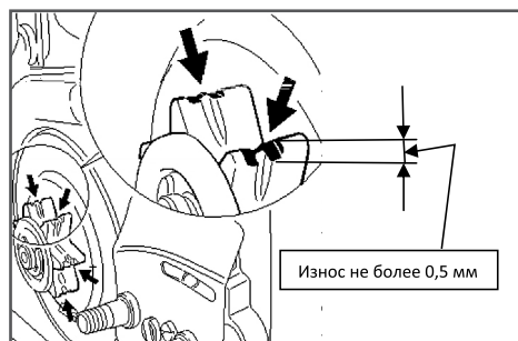
Рис.10 Проверка износа звездочки
