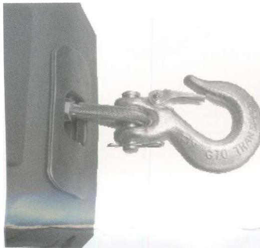
Электрическая лебедка оборудована крюком в сборе, закрепленном на стяжном кольце троса, находящемся внутри задней пластины троса. (см. фотографии)
