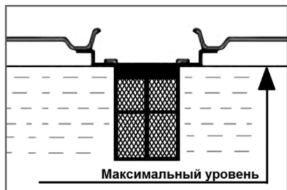
Рис. 9 Максимальный уровень топлива в топливном баке
